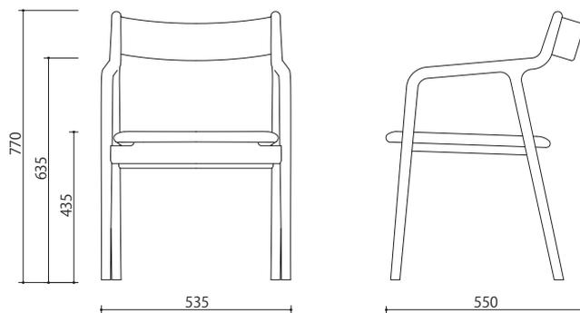
フレームはフィンガージョイントで強度を高め、その接合部をデザインのポイントにしている。脚部先端の断面は円形だがアーム部では丸四角になり、背の先端で再び円になるという変化を持たせている。軽さとゆったりとした座り心地をそなえる。
